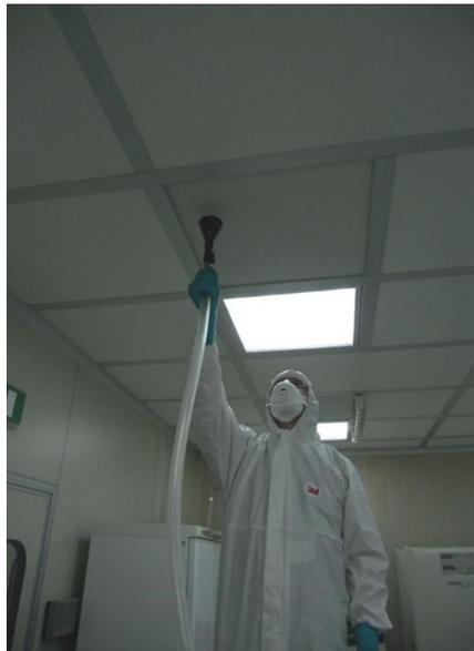
Fig.1 - Test integrità mediante OPC
