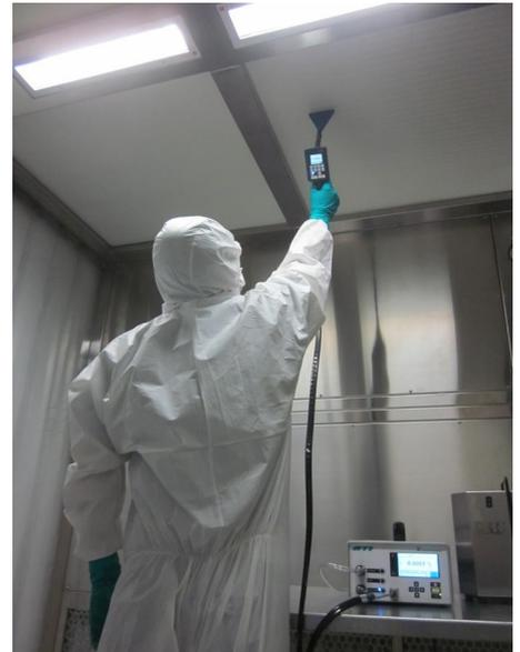
Fig.2 - Test integrità mediante Fotometro
